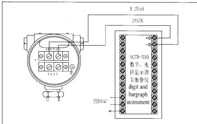
\*UHZ-517BL 系列现场总线产品系统连接采用四线制(两根双绞线)，一根双绞线为电源线，供24VDC电源，无极性要求；另一根双绞线为网络线，无极性要求，但最低为V类非屏蔽双绞线，双绞线的粗细应在AWG16-22之间。
